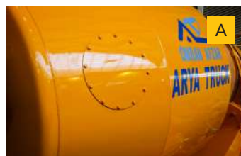
Emergency evacuation valve دریچه تخلیه اضطراری در قسمت عدسی
