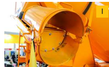
Retaining flap with swivel chute شوت‌بند برای نگهداری بتن سرریز شده
