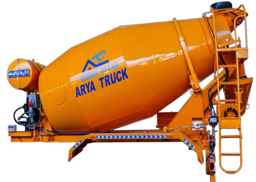
Retaining flap with swivel chute شوت‌بند برای نگهداری بتن سرریز شده
